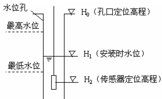
传感器安装布置示意图
